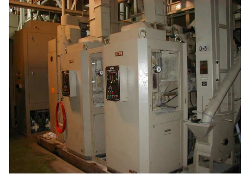
9. ニューコンパス 玄米の穀層を取り除き、精米にします。(研米機内蔵です。)
