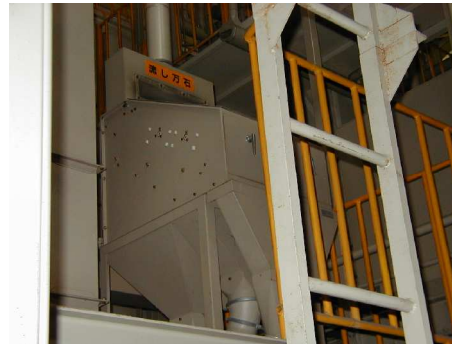
11. 粗選機 (流し万石) 流下式選別機で糠玉を取り除きます。(右図参照)
