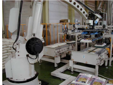
19. ロボットパレタイザー 包装済の製品を種類別にパレットに積み分けます。
