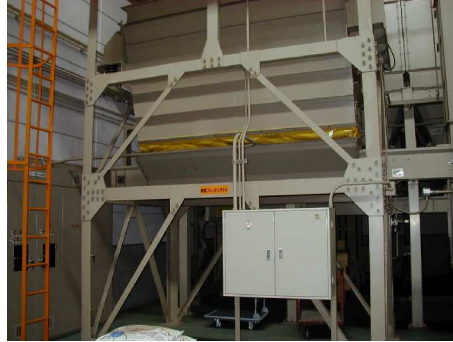
13 . 混米機 精米の品質を一定にするため 混米します。
