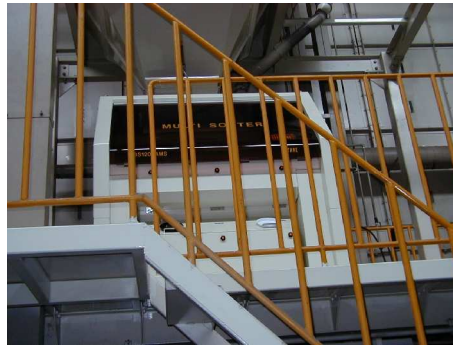
15 . 色彩選別機 精米中の濁色粒を取り除き白米のみにします。 ガラス・プラスチック等の除去も可能です。 (次ページ上段左図参照)
