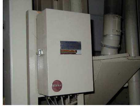
16. 金属検出機 製品中の金属を取り除きます。
