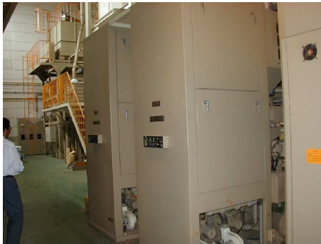
10. 米質改善装置 白米の含有水分を一定にし、食味を向上させます。精米の水分を計測します。
