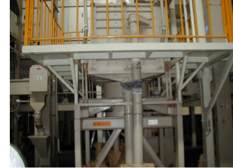
14 . ロータリーシフター 精米中の碎末、殻、殻玉を取り除 きます。(下段左図参照)
