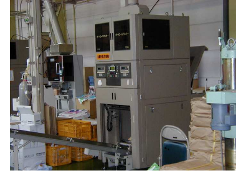
17. 自動計量包装機 製品を自動的に計量し、包装します。
