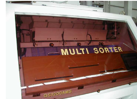
15 . 色彩選別機 精米中の濁色粒を取り除き白米のみにします。 ガラス・プラスチック等の除去も可能です。 (次ページ上段左図参照)
